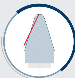
Patentiertes asymmetrisches Design sorgt dafür, dass sich die Kanten wie Zähne in hartes Material verbeißen
