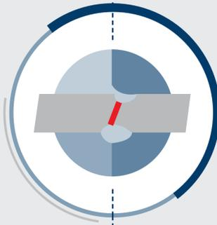
Kurze Querschnide erhöht die Effektivität in härtesten Fliesen
