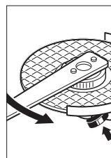
Uma porca de aperto rápido sem danos e bem apertada pode ser solta rodando manualmente o anel serrilhado para a esquerda. **Nunca solte uma porca de aperto rápido presa com um alicate, use antes uma chave de dois furos.** Aplique a chave de dois furos da forma exibida na imagem.
