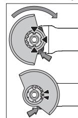
Coloque a tampa de proteção (7) no suporte na ferramenta elétrica, até que os cames de codificação da tampa de proteção coincidam com o suporte. Para tal, pressione e segure a alavanca de desbloqueio (8).
