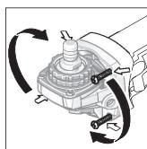
Puede girar la cabeza del engranaje en pasos de 90°. De este modo, el interruptor de conexión/desconexión puede situarse en una posición de manejo más adecuada para casos especiales, por ejemplo, para zurdos.
