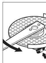
Una tuerca de fijación rápida en buenas condiciones y correctamente fijada, la puede soltar girando el tornillo moleteado con la mano en contra del sentido de giro de las agujas del reloj.
