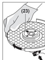
Pressione o botão de bloqueio do eixo (1), para travar o eixo. Para apertar a porca de aperto rápido, rode com força o disco de retificar para a direita.
