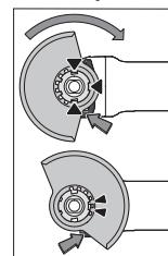
Coloque la cubierta protectora (7) sobre el alojamiento en la herramienta eléctrica, hasta que coincidan las levas de codificación de la cubierta protectora con el alojamiento. Presione y sujetelo en ello la palanca de desenclavamiento (8).
