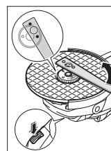
Mur penjepitan cepat yang telah dipasang dengan benar dapat dilepas menggunakan tangan dengan cara memutar cincin bergerigi ke arah yang berlawanan jarum jam. **Jangan melepaskan mur penjepitan cepat yang terpasang kuat dengan tang, melainkan gunakan kunci lubang ganda.** Pasangkan kunci lubang ganda seperti terlihat dalam gambar.
