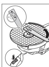
Mehari سریع طبق مقررات تعیین شده و بدون عیب را می توان با چرخاندن رینگ کنگره دار در خلاف جهت عقربه های ساعت با دست باز کرد. Mehari سریع سفت شده را هرگز توسط یک آچار شلاقی باز نکنید، بلکه از یک آچار دو سوزونه استفاده نمایید. آچار دوسوزونه را مانند تصویر قرار دهید.
