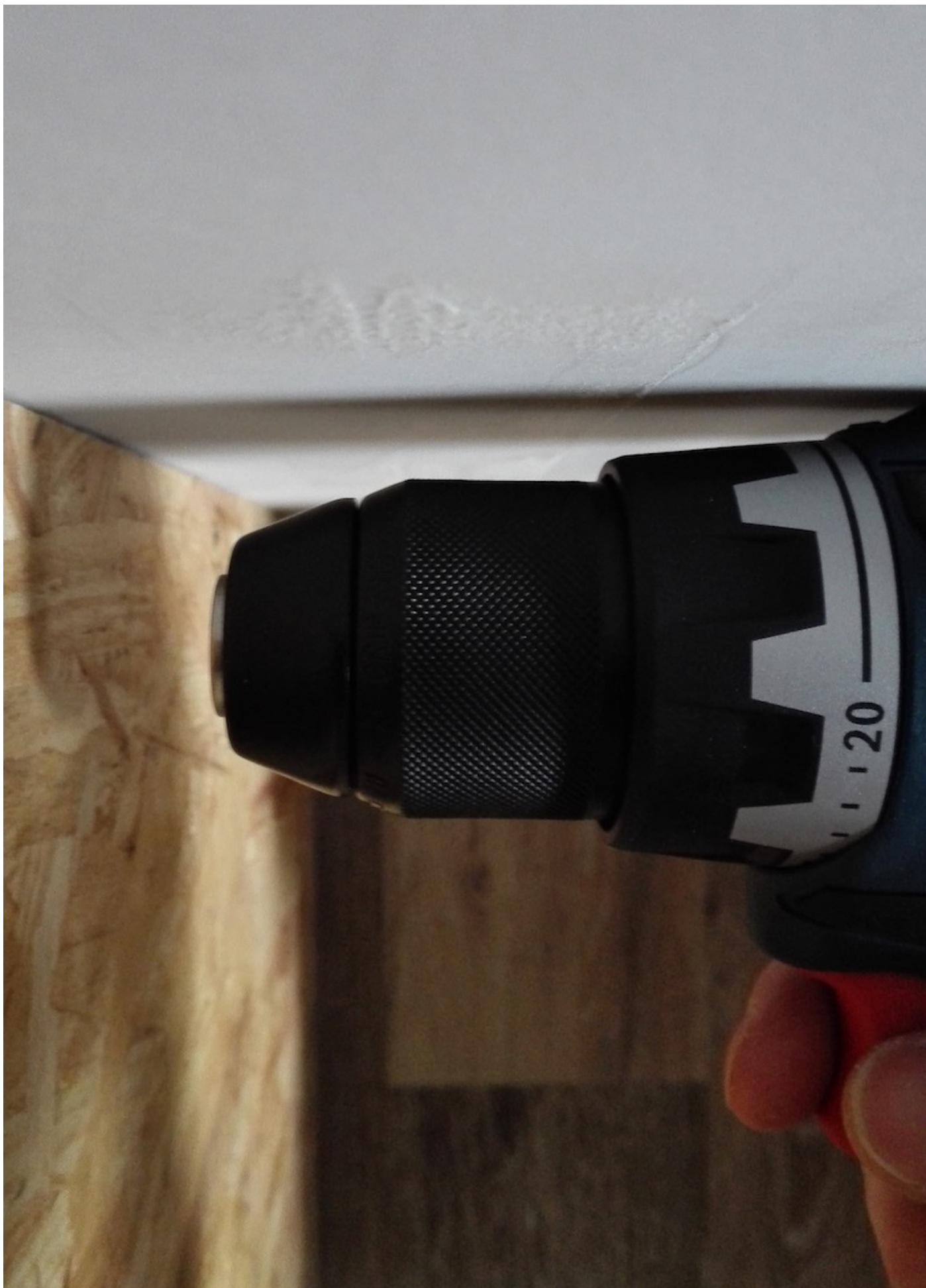
Un mandrin classique ne permet pas de visser parallèlement et au plus près de l'angle
