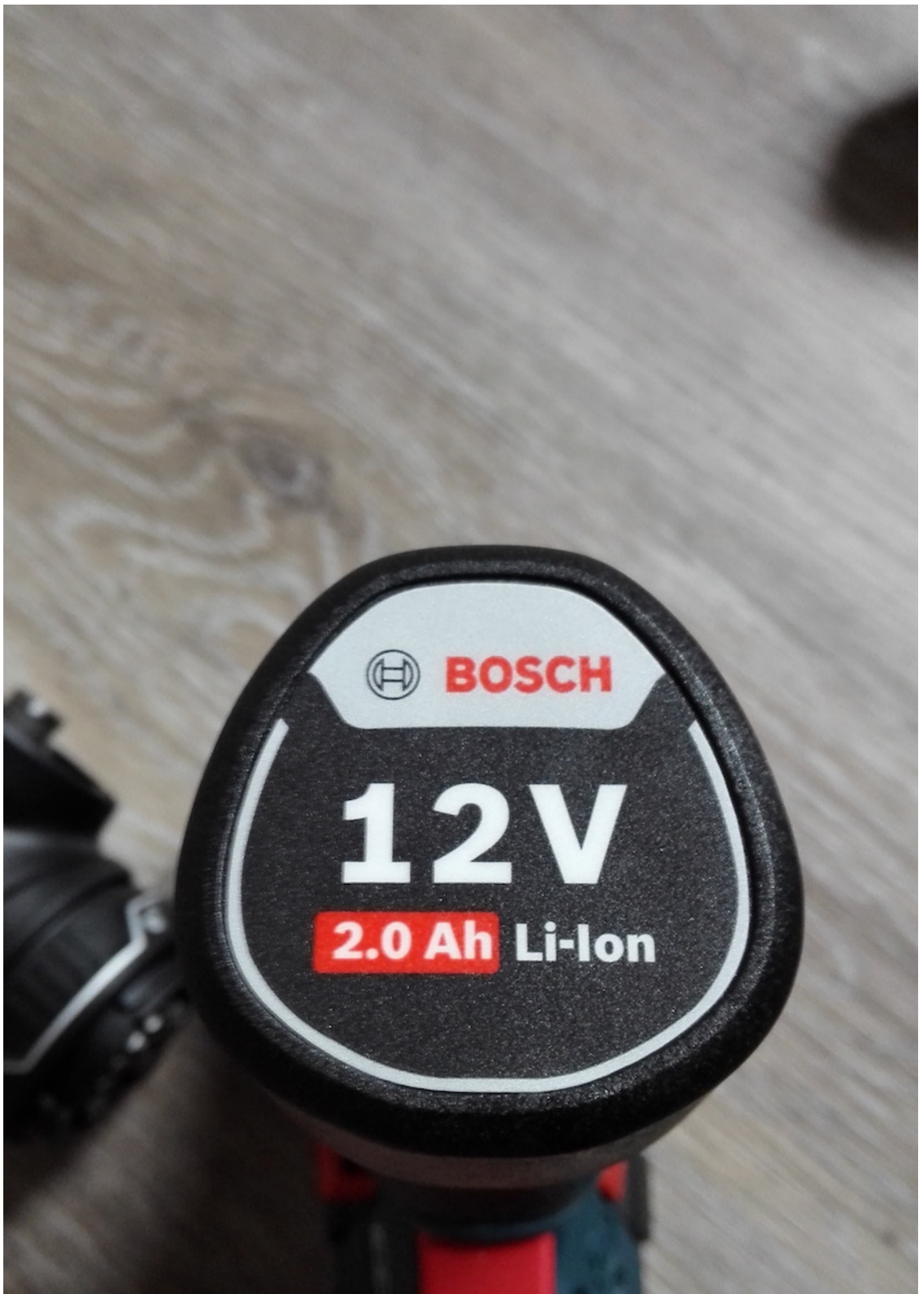
La visseuse GSR12V de Bosch est alimentée par une batterie 12V 2.0Ah Lithium Ion
