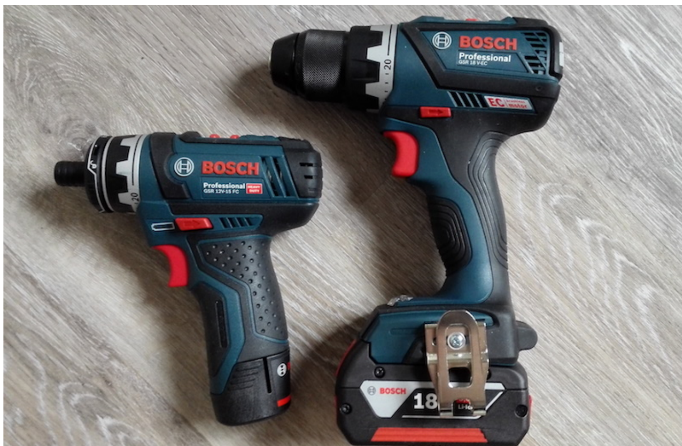
Comparatif d'encombrement de la visseuse Bosch GSR 12V avec le modèle 18V de la même marque
