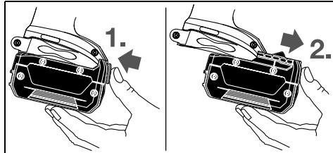
拆卸蓄电池 5 时先按下解锁按键 6 接著再向前从电动工具中拉出蓄电池。不可以强行拉出蓄电池。
