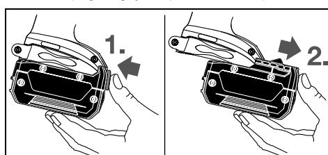
Để tháo pin 5, nhấn núm nhả khóa 6 và kéo hết pin ra về phía trước. Không dùng lực cưỡng ép.
