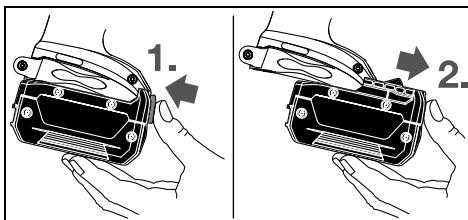
배터리 5를 빼려면 해제 버튼 6을 누른 상태에서 배터리를 전동공구 앞쪽으로 잡아 당깁니다. 무리하게 힘을 가하지 마십시오.
