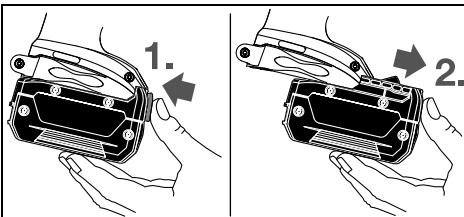
**拆卸蓄電池 5 時先按下解鎖按鍵 6，接著再向前從電動工具中拉出蓄電池。不可以強行拉出蓄電池。**
