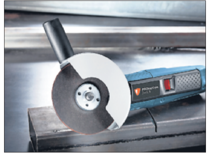
Hele startknappen, som stort set strækker sig fra top til bund, af maskinen er samtidig en dødemandsknap.
