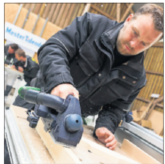
Den nye høvl fra Festool vejer kun 2,4 kg. og er nem at arbejde med. Foto: John Ehbrecht.
