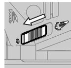
Mematikan alat peniup serbuk: Untuk pekerjaan di logam serta jika disambungkan penghisapan debu, dorongkan tombol **8** dalam arah mata gergaji.
