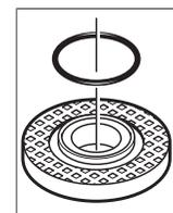
En la brida de alojamiento (7) hay una pieza de plástico (anillo tórico) alrededor del collar de centrado. **Si el anillo tórico falta o está dañado, es imprescindible sustituir la brida de alojamiento (7) antes de la reutilización.**
