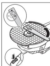
Uma porca de aperto rápido sem danos e bem apertada pode ser solta rodando manualmente o anel serrilhado para a esquerda. **Nunca solte uma porca de aperto rápido presa com um alicate, use antes uma chave de dois furos.** Aplique a chave de dois furos da forma exibida na imagem.
