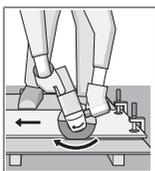
A ferramenta elétrica deve sempre ser conduzida no sentido contrário da rotação. Caso contrário, existe perigo de a ferramenta ser pressionada de forma **descontrolada** sobre o corte. Ao separar perfis e tubos quadrados comece de preferência na seção transversal mais pequena.
