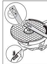
Una tuerca de fijación rápida en buenas condiciones y correctamente fijada, la puede soltar girando el tornillo moleteado con la mano en contra del sentido de giro de las agujas del reloj. **No suelte nunca una tuerca de fijación rápida inmovilizada con unas tenazas, sino utilice la llave de dos pivotes como se muestra en la imagen.**
