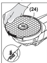
Pressione a tecla de bloqueio do veio (1), para fixar o veio de trabalho. Para apertar a porca de aperto rápido, rode com força o disco de retificar para a direita.
