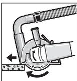
Ligue a ferramenta elétrica e coloque-a com a parte da frente do carrinho guia sobre a peça. Deslize a ferramenta elétrica com um avanço moderado, adequado para o material a ser trabalhado.
