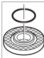
No flange de admissão (7) existe em volta do colar central um anel de plástico (O-ring). **Se o O-ring estiver ausente ou danificado, é essencial substituir o flange de admissão (7) antes de uma reutilização.**
