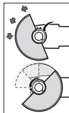
Abrir a alavanca de aperto ou soltar o parafuso de fixação.
