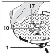
Fixar o eixo de trabalho com o botão de travamento de eixo 1. Apertar a porca de aperto rápido girando firmemente o disco abrasivo no sentido dos ponteiros do relógio.
