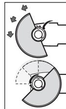
Insertar los resaltes de codificación de la caperuza protectora en las ranuras del cuello del husillo que incorpora el cabezal del aparato, y girar la caperuza en sentido contrario a las agujas del reloj a la posición requerida (posición de trabajo).
