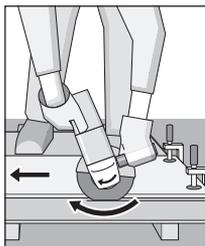
Não travar discos abrasivos de corte, pressionando-os lateralmente.
