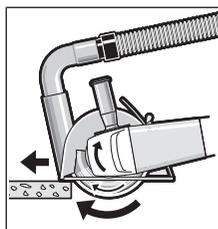
Schalten Sie das Elektrowerkzeug ein und setzen Sie es mit dem vorderen Teil des Führungsschlittens auf das Werkstück. Schieben Sie das Elektrowerkzeug mit mäßigem, dem zu bearbeitenden Material angepasstem Vorschub.
