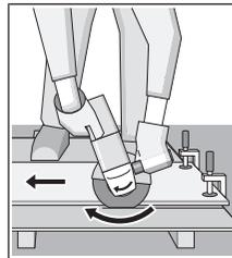
Elverket måste alltid föras med motrotation. Annars föreligger risk för att den trycks ut ur kapningen **okontrollerat**. Vid kapning av profiler och fyrkantör är det bäst att sätta an där diametern är som minst.
