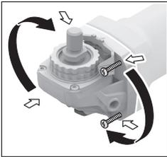
Головку редуктора можна повертати з інтервалом у 90°. Це забезпечує кращий доступ до вимикача при виконанні певних робіт, напр., якщо Ви лівша.
