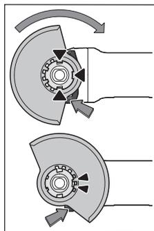
Læg beskyttelseskappen (9) på holderen på el-værktøjet, til beskyttelseskappens kodeknaster stemmer overens med holderen. Tryk og hold herunder frigøringsarmen (1).
