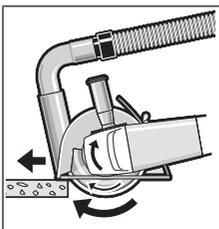
Kapcsolja be az elektromos kéziszerszámot és tegye rá a vezetősán első részével a munkadarabra. Az elektromos kéziszerszámot mérsékelt, a megmunkálásra kerülő anyagnak megfelelő előtolással tolja előre.
