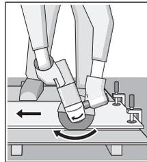
Elektronarzędzie należy zawsze prowadzić przeciwnie do kierunku obrotów tarczy. W przeciwnym razie istnieje niebezpieczeństwo, że zostanie ono w sposób **niekontrolowany** wypchnięte ze szczeliny. W przypadku cięcia profili i rur czworokątnych, zaleca się zacząć pracę od najmniej-
