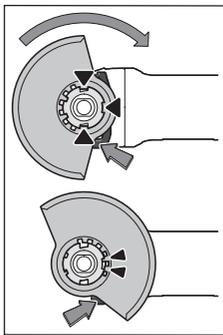
Coloque la cubierta protectora (9) sobre el alojamiento en la herramienta eléctrica, hasta que coincidan las levas de codificación de la cubierta protectora con el alojamiento. Presione y sujete en ello la palanca de desenclavamiento (1).
