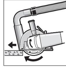
قم بتشغيل العدة الكهربائية، وضعها على قطعة الشغل من الجزء الأمامي لدليل التوجيه. قم بتحريك العدة الكهربائية مع دفع أمامي معتدل مناسب للخامة التي تتم معالجتها.
