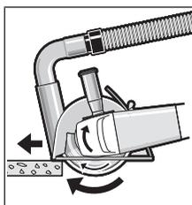
Ieslēdziet elektroinstrumentu un novietojiet griešanas vadotnes priekšējo malu uz apstrādājamā priekšmeta. Pārvietojiet elektroinstrumentu ar mērenu ātrumu, kas atbilst apstrādājamā materiāla īpašībām.
