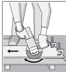
Električni alat morate stalno da vodite u suprotnom smeru. Inače postoji opasnost da se **nekontrolisano** potisne iz reza. Prilikom razdvajanja profila i četvorougaoone cevi najbolje je da postavite najmanji poprečni presek.
