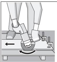
Az elektromos kéziszerszámot mindig a forgásirányával ellentétes irányban kell vezetni. Ellenkező esetben a készülék **irányíthatatlanul** kiugorhat a vágásból. Profilok és négyzetleges csövek darabolásánál a legcélszerűbb a legkisebb keresztmetszetnél kezdeni a darabolást.
