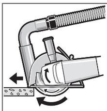
Vklopite električno orodje in ga s sprednjim delom vodila namestite na obdelovanec. Potiskanje električnega orodja prilagodite obdelovancu.
