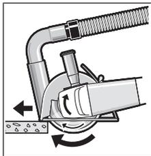
Włączyć elektronarzędzie i oprzeć je przednią częścią przewodnicy saneczkowej o obrabiany element. Pracować z równomiernym posuwem, dostosowanym do właściwości obrabianego materiału.
