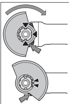
Ставете го заштитниот капак (9) на прифатот од електричниот алат, додека кодираните запци на заштитниот капак не се поклопат со прифатот. Притоа, притиснете го и држете го лостот за отклучување (1).
