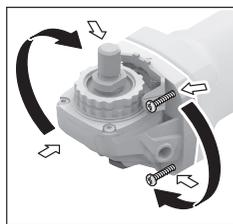
Корпус редуктора может поворачиваться с интервалом в 90°. Этим выключатель может быть поставлен в удобное для работы положение, например, для левши.
