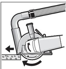
Zapnite elektrické náradie a priložte ho prednou časťou vodiacich saní na obrobok. Posúvajte elektrické náradie s miernym posúvaním, prispôsobeným opracovávanému materiálu.
