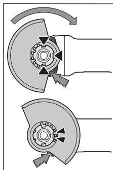
Așezați capacul de protecție **(9)** pe sistemul de prindere al sculei electrice, potrivindu-l până când camele de codificare ale apărătoarei de protecție se suprapun pe sistemul de prindere. Apăsăți și țineți apăsată în acest timp pârghia de deblocare **(1)**. Apăsăți capacul de protecție **(9)** pe gulerul axului până când colierul capacului de protecție este fixat de flanșa sculei electrice și rotiți capacul de protecție până
