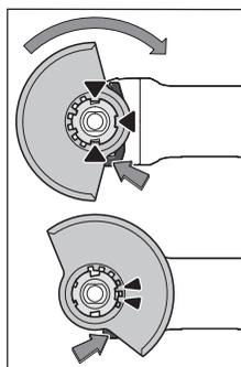
Placez le capot de protection (9) sur la fixation de l'outil électroportatif jusqu'à ce que les ergots de codage du capot de protection viennent se loger dans les évidements de la fixation. Appuyez pour cela sur le levier de déverrouillage (1) et maintenez-le actionné. Montez le capot de protection (9) sur le collet de broche en exerçant une pression jusqu'à ce que l'épaulement du capot de protection repose sur le flasque de l'outil
