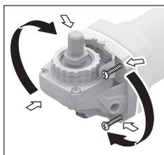
Možete okretati glavu prenosioca u koracima od 90°. Na taj način možete prekidač za uključivanje-isključivanje za posebne slučajeve u radu dovesti u povoljniju poziciju za držanje ruke, na primer za levoruke.
