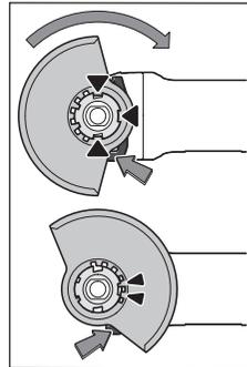
안전반의 코딩 홈과 홀더가 일치하도록 안전반 (9) 을 전동공구의 홀더에 끼우십시오. 이때 해제 레버 (1) 를 누르고 계십시오. 안전반의 끝이 전동공구 플랜지에 맞을 때까지 안전반 (9) 을 스프링 칼라 위로 누르고, 확실히 걸리는 소리가 날 때까지 안전반을 돌립니다. 작업에 필요한 상태로 안전반 (9) 의 위치를 조절하십시오. 이때 해제 레
