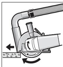
Ενεργοποιήστε το ηλεκτρικό εργαλείο και ακουμπήστε το με το μπροστινό μέρος του πέλατος οδήγησης πάνω στο επεξεργαζόμενο κομμάτι. Σπρώξτε το ηλεκτρικό εργαλείο με μέτρια προώθηση, προσαρμοσμένη στο επεξεργαζόμενο υλικό.
