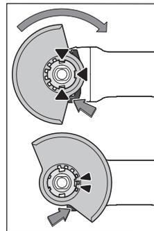
Novietojiet aizsargpārsegu (9) uz elektroinstrumenta stiprinājuma tā, lai pārsega kodēšanas izciļņi sakristu ar stiprinājuma gropēm. Nospiediet un turiet nopiestu atbloķēšanas sviru (1).
