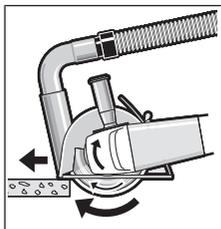
Uključite električni alat i prednjim delom vodećih šina ga stavite na radni komad. Električni alat pomicite ravnomerno, prilagođeno materijalu koji se obrađuje.
