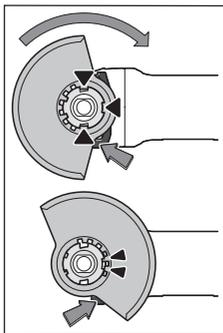
Applicare la cuffia di protezione (9) nell'alloggiamento dell'elettrotensile, sino a quando le camme di codifica della cuffia stessa coincidano con l'alloggiamento. A tale scopo, premere e mantenere premuta la leva di sbloccaggio (1).
