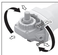
La tête de meuleuse peut être tournée par pas de 90°. Cela permet, lors de certaines applications, d'amener l'interrupteur Marche/Arrêt dans une meilleure position de prise en main, par ex. pour les gauchers. Retirez les 4 vis. Faites pivoter avec précaution la
