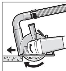
Sätt på elverket och sätt det med den främre delen av styrskenan på arbetsstycket. Skjut elverket med jämna drag som är anpassade efter materialet.
