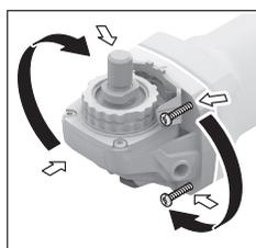
Puede girar la cabeza del engranaje en pasos de  $90^\circ$ . De este modo, el interruptor de conexión/desconexión puede situarse en una posición de manejo más adecuada para casos especiales, por ejemplo, para zurdos.
