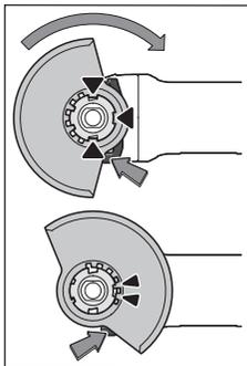
Coloque a tampa de proteção (9) no encaixe na ferramenta elétrica até as saliências de codificação da tampa de proteção coincidirem com o encaixe. Para tal, prima e segure a alavanca de destravamento (1).
