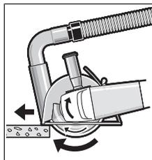
Slå på elektroverktøyet, og sett det på emnet med den fremre delen av føringssslissen. Skyv elektroverktøyet med moderat hastighet, tilpasset materialet som bearbeides.
