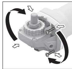
Vaihteiston päätä voi kääntää 90 astetta kerrallaan. Näin käyttökytkimen voi sijoittaa parempaan asentoon erilaisia käyttötilanteita varten, esim. jos koneen käyttäjä on vasenkätinen.
