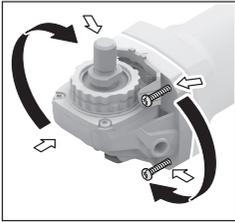
Sie können den Getriebekopf in 90°-Schritten drehen. Dadurch kann der Ein-/Ausschalter für besondere Arbeitsfälle in eine günstigere Handhabungsposition gebracht werden, z. B. für Linkshänder.
