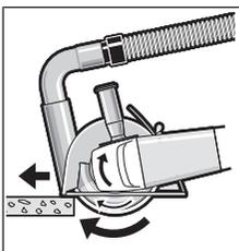
Uključite električni alat i stavite ga na izradak s prednjim dijelom vodilice. Pomicite električni alat umjerenim pomakom prilagođenim materijalu koji obrađujete.
