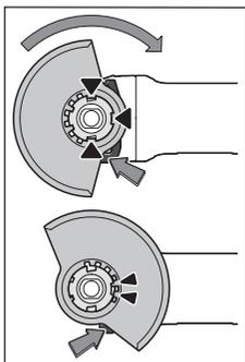
Lägg skyddskåpan (9) på elverktygets hållare tills kodningen på skyddskåpan stämmer överens med hållaren. Tryck och håll inne låset (1).
