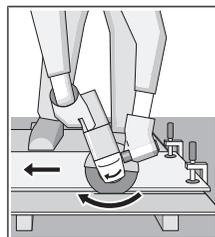
Električni alat mora se uvijek voditi protuhodno. U suprotnom postoji opasnost da se **nekontrolirano** istisne iz reza. Kod rezanja profila i četverokutnih cijevi najbolje je da stavite na najmanji presjek.
