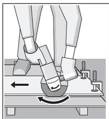
A ferramenta elétrica tem de ser sempre conduzida no sentido oposto às rotações. Caso contrário há risco que a ferramenta seja pressionada de forma descontrolada para fora do corte. Para cortar perfis e tubos quadrados o melhor será aplicar pequenos cortes transversais.
