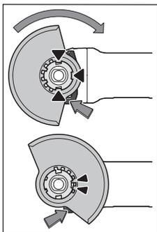
Aseta suojuus (9) sähkötyökulun kiinnittimeen niin, että suojuksen koodausnokat ovat kohdakkain kiinnittimen kanssa. Paina ja pidä tällöin lukituksen avausvipua (1) painettuna.
