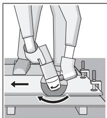
Elektrické nářadí je nutné vést vždy protiběžně. Jinak hrozí nebezpečí, že dojde k jeho **nekontrolovanému** vytlačení z řezu. Při řezání profilů a čtyřhranných trubek je nejlepší nasadit nářadí v místě nejmenšího průřezu.
