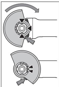
Zaščitni pokrov (9) položite na vpetje na električnem orodju, pri čemer se morajo kodirni nastavki zaščitnega pokrova ujemati z vpetjem. V ta namen pritisnite in držite sprostitveno ročico (1). Zaščitni pokrov (9) pritisnite na steblo vretena, da rob zaščitnega pokrova nasede na prirobnico električnega orodja, nato zaščitni pokrov obrnite, da se slišno zaskoči. Položaj zaščitnega pokrova (9) prilagodite zahtevam
