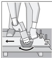
Всегда ведите электроинструмент против направления вращения. В противном случае существует опасность неконтролируемого вырывания инструмента из проresi. При резке профилей или четырехгранных труб начинайте рез на наименьшем поперечном сечении.
