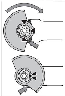
Покладіть захисний кожух (9) на кріплення на електроінструменті так, щоб кодовані кулачки захисного кожуха відповідали кріпленню. При цьому натисніть і тримайте натисненим розблокувальний важіль (1).
