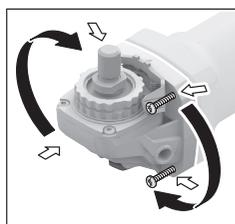
Glavu prijenosnika možete zakrenuti u koracima od 90°. Na taj se način prekidač za uključivanje/isključivanje može prebaciti u povoljniji položaj rukovanja za posebne slučajeve primjene, npr. za ljevake.
