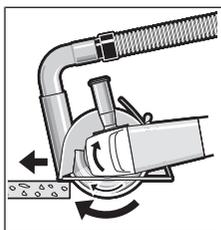
Zapnete elektrické nářadí a nasadíte ho přední částí vodicích saní na obrobek. Posunujte elektrické nářadí s mírným posuvem přizpůsobeným obráběnému materiálu. Při dělení mimořádně tvrdých materiálů, např. betonu s vysokým podílem
