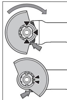
Қорғағыш қаптаманы (9) электр құралының патронына қорғағыш қаптамасының кодтау жұдырықшалары патронға сәйкес келгенше салыңыз. Бұғаттаудан шығару иінірегін (1) басып ұстаңыз. Шпиндель мойнындағы қорғағыш қаптаманы (9) басып, қаптамадағы буртикті электр құралдың фланеціне отырғызыңыз және қорғағыш қаптаманы
