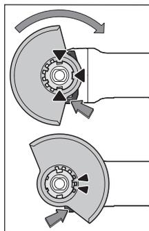
Положите защитный кожух (9) на крепление на электроинструменте так, чтобы кодирующие кулачки защитного кожуха соответствовали креплению. При этом нажмите и держите нажатый рычаг разблокировки (1).
