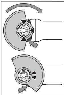
Nasadte ochranný kryt (9) pro upínání na elektronářadí tak, aby kódovací výstupky ochranného krytu souhlasily s upínáním. Stiskněte a držte přitom stisknutou odjišťovací páčku (1). Přitlačte ochranný kryt (9) na krk vřetena tak, aby nákržek ochranného krytu dosedal k přírubě elektronářadí a otáčejte ochranným krytem, dokud slyšitelně nezaskočí.
