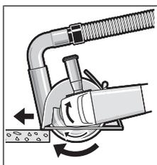
Elektrinį įrankį įjunkite ir kreipiamųjų pavažų priekine dalimi pridėkite prie ruošinio. Stumkite elektrinį įrankį pagal apdorojamą paviršių pritaikyta pastūma.
