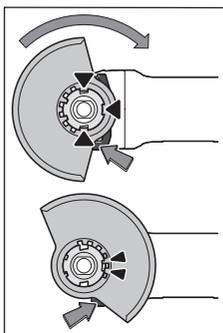
Legen Sie die Schutzhaube (9) auf die Aufnahme am Elektrowerkzeug, bis die Codiernocken der Schutzhaube mit der Aufnahme übereinstimmen. Drücken und halten Sie dabei den Entriegelungshebel (1).
