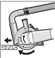
Kytke sähkötyökalu päälle ja aseta se ohjaustuen etuosan kanssa työkappaleelle. Työnnä sähkötyökalua eteenpäin rauhallisella, työstettävälle materiaalille sopivalla vauhdilla.
