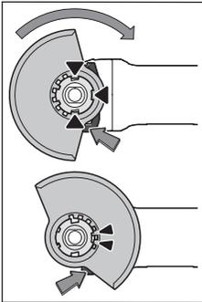
Tegye rá a (9) védőbúrát az elektromos kéziszerszám fogadó egységére, amíg a védőbúra kódoló billentyűi meg nem felelnek a fogadóegységnek. Eközben nyomja be és tartsa benyomva a (1) reteszelés feloldó kart.
