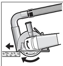
Включите электроинструмент и приставьте переднюю часть направляющих салазок к обрабатываемой заготовке. Ведите электрический инструмент с равномерной, рассчитанной на обрабатываемый материал подачей.
