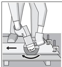
Griešanas laikā elektroinstrumentu vienmēr jāpārvieto atpakaļvirzienā. Pretējā gadījumā pastāv iespēja, ka griešanas disks tiks **nekontrolēti** mests ārā no griezuma. Griežot profilus un četrstūra caurules, ieteicams uzstāt griešanu vietā ar vismazāko šķērsriezuma laukumu.
