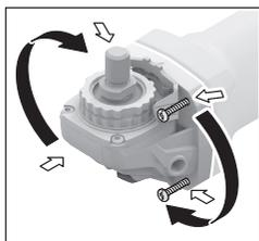
Reduktora galvu var pagriezt 90° iedalījumos. Atsevišķiem darbiem var izvēlēties izdevīgāku ieslēdzēja/izslēdzēja novietojumu, piemēram, ja instrumentu lieto kreilis. Izskrūvējiet 4 skrūves. Uzmanīgi pagrieziet reduktora galvu vēlāmajā
