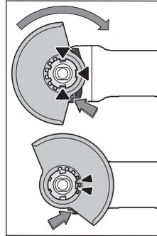
Koruyucu kapağı (9) kod tırnakları yuvaya uyum sağlayacak biçimde elektrikli el aleti yuvasına yerleştirin. Boşa alma tuşuna (1). basın ve tuşu basılı tutun Koruyucu kapağı (9) koruyucu kapağın kemeri elektrikli el aletin flanşı üzerine oturuncaya kadar bastırın ve işitilir biçimde kavrama yapıncaya kadar koruyucu kapağı çevirin. Koruyucu kapağın (9) pozisyonunu yaptığımız işin
