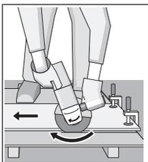
Elektroverktøyet må alltid føres i motløp. Ellers er det fare for at det trykkes **ukontrollert** ut av snittet. Ved kapping av profiler og firkantør lønner det seg å begynne kappingen på det minste tverrsnittet.
