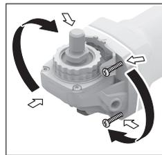
Hlavu převodovky můžete otáčet v krocích po 90°. Tím lze dosáhnout toho, že vypínač bude při zvláštních pracovních situacích v příhodnější poloze pro manipulaci, např. pro leváky.
