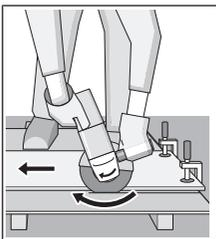
El-værktøjet skal altid føres i modløb. Ellers er der risiko for, at det **ukontrolleret** trykkes ud af snittet. Ved skæring af profiler og firkantrør er det bedst at starte ved det mindste tværsnit.
