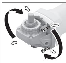
A hajtóműfejet 90°-os lépésekben el lehet forgatni. Így a be-/kikapcsolót különleges munkavégzési esetekhez, például balkezes kezelők számára, egy előnyösebb helyzetbe lehet hozni. Teljesen csavarja ki a 4 csavart. Óvatosan, **és anélkül, hogy levénne a házról,** for-
