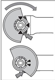
Ochranný kryt (9) položte na uchytenie na elektrickom náradí tak, aby sa kódovacie narážky ochranného krytu zhodovali s uchytením. Stlačte a pritom držte odistovaciu páčku (1).
