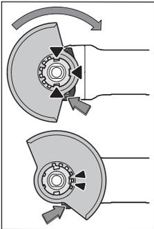
Uždėkite apsauginį gaubtą (9) ant elektrinio įrankio laikiklio, kad apsauginio gaubto kodiniai kumšteliai sutaptų su laikikliu. Paspauskite ir laikykite paspaustą atblokovimo svirtelę (1).
