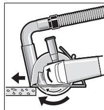
Porniți scula electrică și așezați-o cu partea frontală a saniei de ghidare, pe piesa de prelucrat. Împingeți scula electrică exercitând un avans moderat, adaptat la materialul de prelucrat. La tăierea materialelor foarte dure, precum betonul cu un conținut ridicat de pietriș, discul de tăiere diamant se poate supraîncălzi și suferi deteriorări. O coroană
