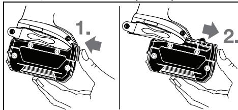
Para remover la batería 4, presione el botón de destrabar 5 y remueva la batería para adelante. **No efectúe ningún esfuerzo.**
