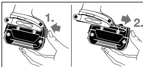
Para remover a bateria 4, pressione o botão de destravamento 5 e remova a bateria para a frente. **Não faça qualquer esforço.**
